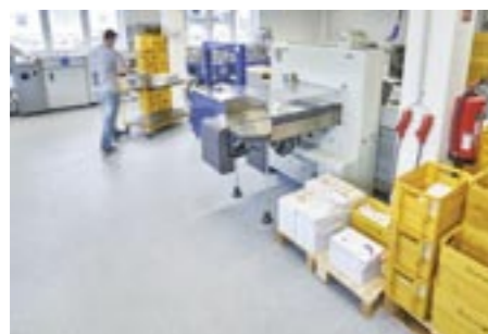
GTI hat rutschhemmende Eigenschaften (R10) und sorgt auch in feuchtem und staubigem Zustand für Sicherheit
